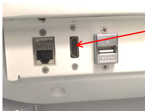
11. ábra: A második monitor kimeneti (HDMI) csatlakozója
