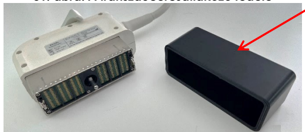
32. ábra: Zárható transzducercsatlakozó-fedél
