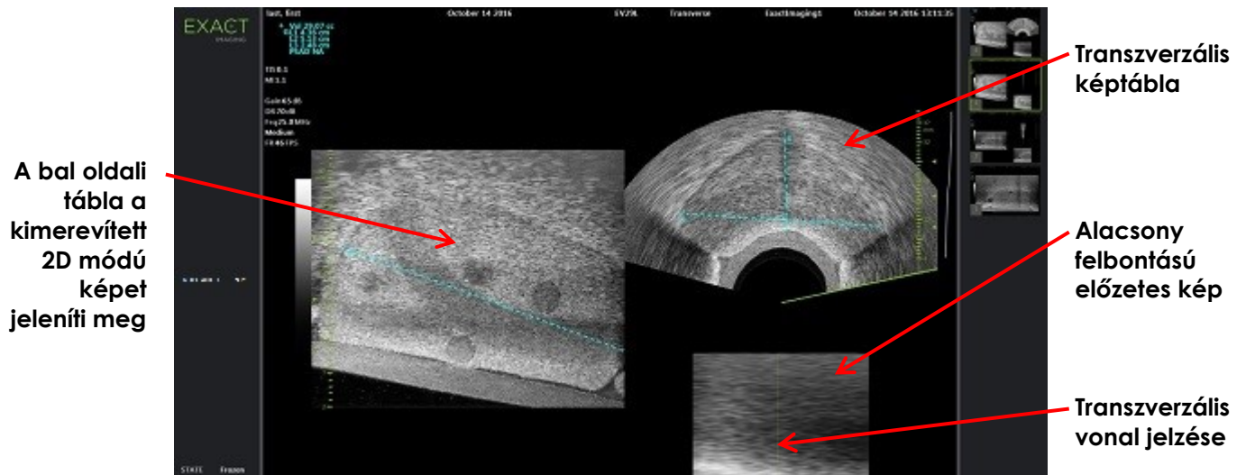
46. ábra: Transzverzális mód a transzverzális kép felépítése után
