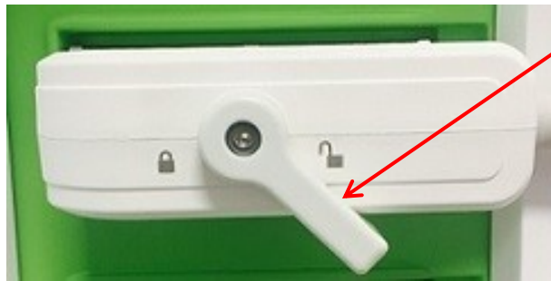
30. ábra: A transzducercsatlakozó rögzítógombja kioldva
