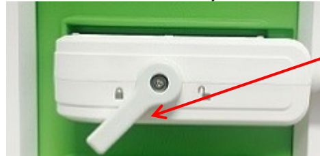
21. ábra: A transzducercsatlakozó tájolása
