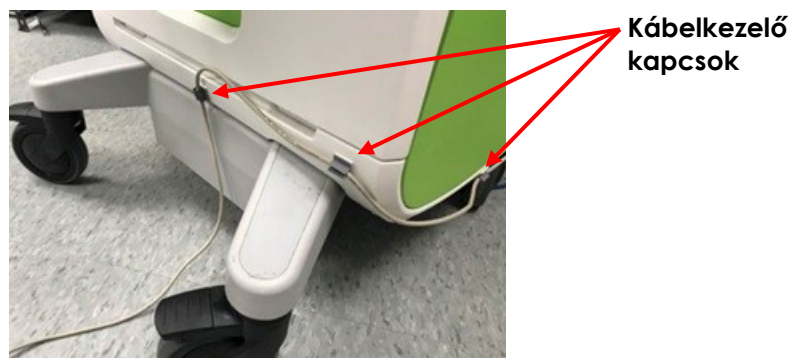
4. ábra: A lábkapcsoló kábelének kezelése
