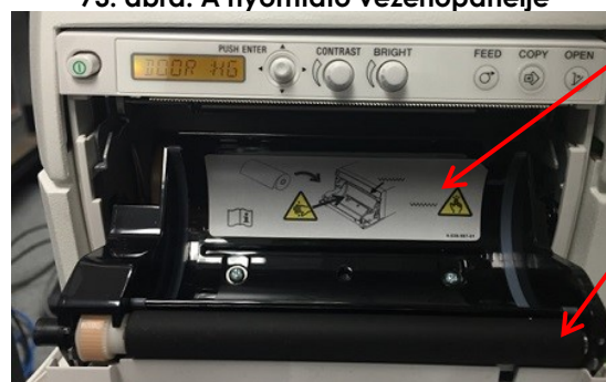
74. ábra: A nyomtató ajtópaneljének nyitása
