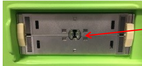
20. ábra: A transzducercsatlakozóaljzaton lévő reteszelőnyílás
